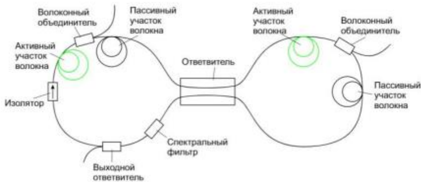
Рис. 1: Принципиальная схема волоконного лазерного резонатора с петлевым усиливающим зеркалом с двумя участками усиления.
