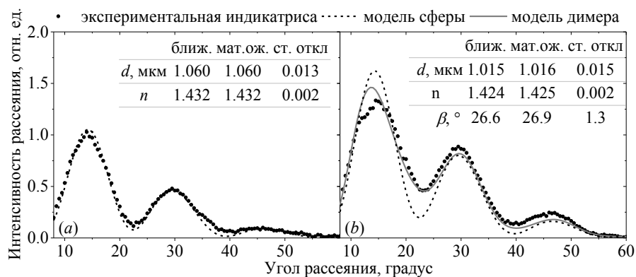
Рис. 5. Типичные экспериментальные и ближайшие теоретические индикатрисы для (a) микрококка (модель сферы) и (b) диплококка (модель димера) Micrococcus spp. 389. Для диплококка также приведена ближайшая теоретическая индикатриса по теории Ми. Также приведены характеристики клеток (ближайшие, математическое ожидание и стандартное отклонение).
